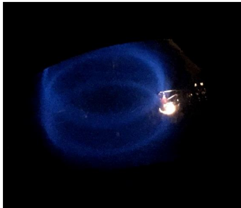
Abbildung 22: Spiralförmiger Elektronenstrahl in der Fadenstrahlröhre
