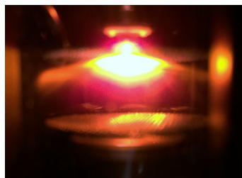
Abbildung 11: Gezündete Ne-Röhre (Kathode unten)
