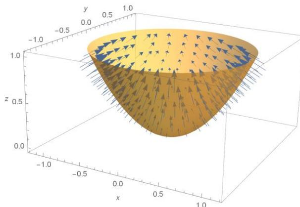
Abbildung 2: Normalvektoren „von außen nach innen“ auf die Fläche  $\vec{s}(r, \varphi) = \begin{pmatrix} r \cos(\varphi) \\ r \sin(\varphi) \\ r^2 \end{pmatrix}$ .
